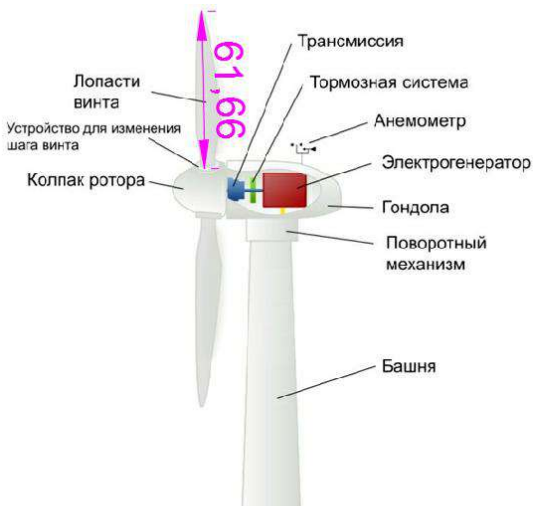
Рисунок 62. Типичные элементы конструкции ветрогенераторной установки
