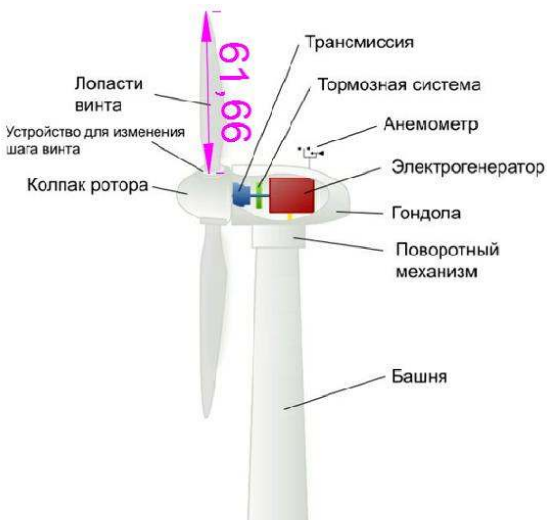
Рисунок 62. Типичные элементы конструкции ветрогенераторной установки
