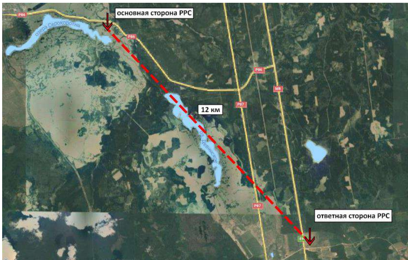
Рисунок 6 – Схема радиорелейного пролета объекта на 11 ГГц
